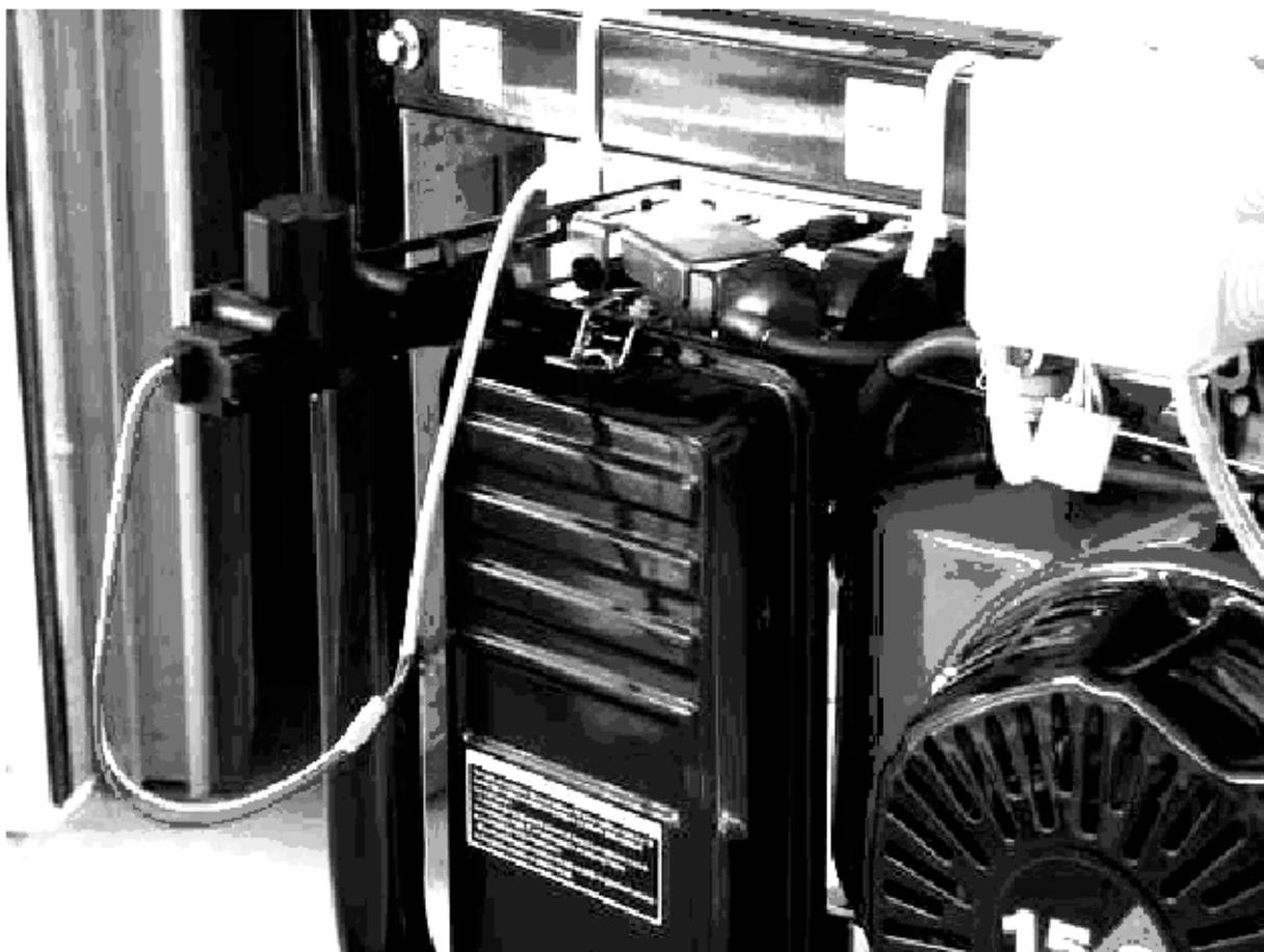
Рис.2 Установленный привод заслонки
